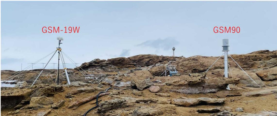
図 2 かさ上げの効果確認のための比較観測
