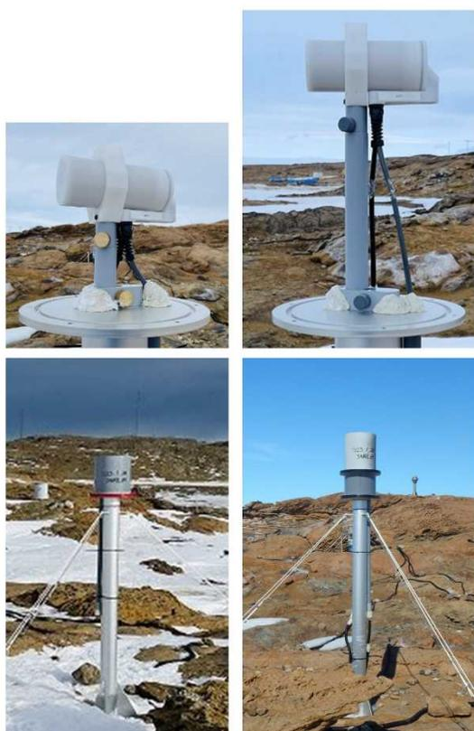
図 1 かさ上げ前後のセンサの状態 (左上：かさ上げ前の内部、右上：かさ上げ後の内部、左下：かさ上げ前の外観、右下：かさ上げ後の外観)
