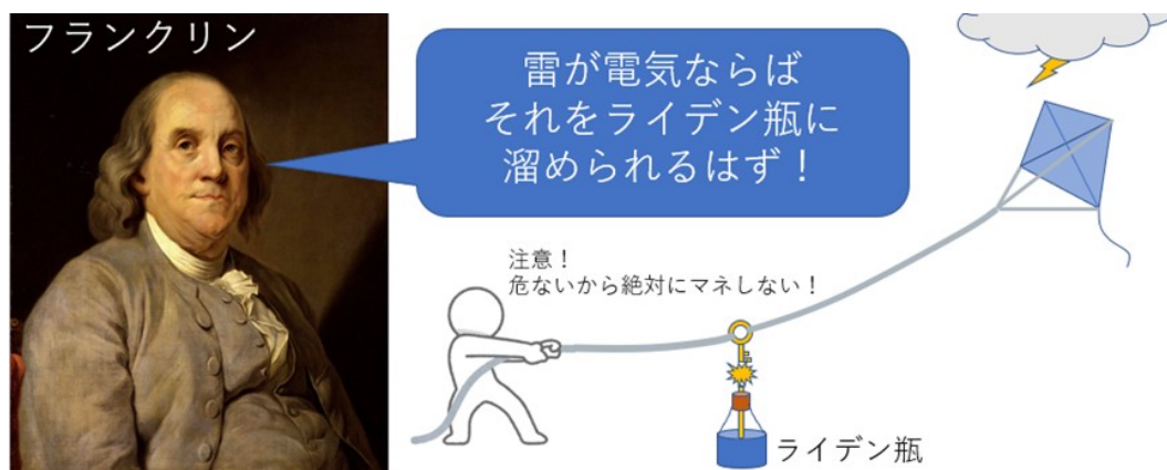
図1：フランクリンの凧あげ実験 たこ糸の途中に金属のカギをつけ、そこからライデン瓶に電気を送る
